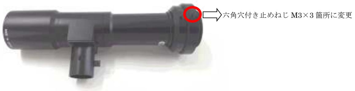
同軸落射仕様時にスポット照明差し込み部を所定の位置に回転移動させた後に固定する六角穴付き止めねじ 3箇所です。
